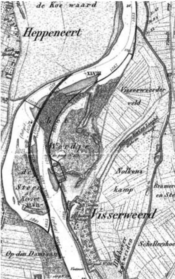
7 – HET DORPJE VISSERSWEERT AAN DE MAAS, OMGEVEN DOOR DE GRIND- EN ZANDBANKEN VAN EEN RIVIER MET MEERDERE GEULEN, EN EILANDEN BEGROEID MET OOBOS. DE DIKKE LIJNEN GEVEN DE DAMMEN EN DE NIEUWE STANDAARD GEUL AAN VAN DE GENORMALISEERDE MAAS. ROND 1860 WERD DE NORMALISATIE UITGEVOERD. RIVIERKAART MAAS, 1880.
