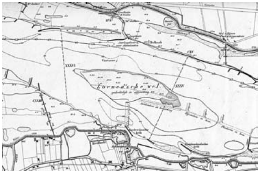
2 - DE NORMALISATIE VAN DE WAAL. DE NOORDELIJKE HELFT VAN DE PLAAT BIJ EWIIJK, HIER LOENENSE WEL GENOEMD, ZAL WORDEN AFGEGRAVEN. DE ZUIDELIJKE RIVIERARM WORDT DOOR EEN DAM AFGESLOTEN, EN ER WORDEN NIEUWE KRIBBEN AANGELEGD. RIVIERKAART VAN DE WAAL, 1870. HIER WERD DE WAAL GEFIXEERD IN DE GEDAANTE DIE DE RIVIER NU NOG HEEFT.
